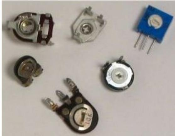
Sono impiegati nella fase di taratura dei circuiti stessi, vale a dire permette la regolazione fine dei valori elettrici del circuito, per farli coincidere con le specifiche del progetto, vengono anche impiegati quando sia prevista la calibrazione periodica del circuito, come avviene in molti strumenti di misura elettronici.
